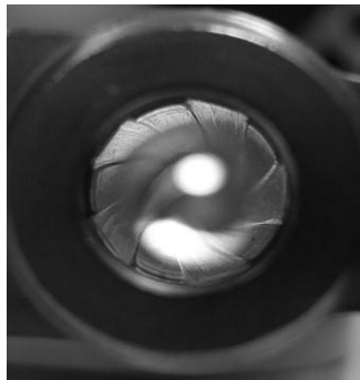
圖5 槍管內右旋來復線之形態
