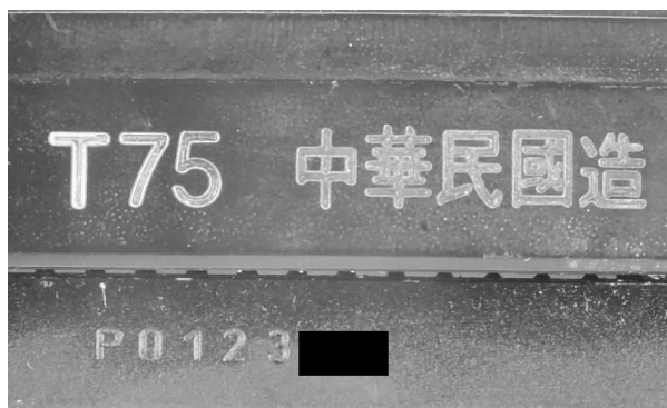
圖 2 槍枝標記可供辨識製造國、型號和槍枝序號
